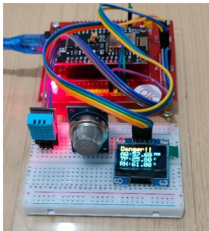
Gambar 2. Alat Saat Menyala dan Menampilkan Data pada Layar LCD
